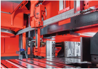
Aufgeräumter Arbeitsraum für optimales Spanmanagement
